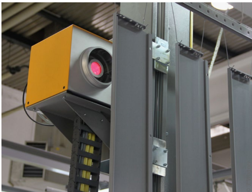
Die Schichtstärke wird kontinuierlich vor dem Einbrennen aus einer Distanz zwischen 5 und 50 cm gemessen. Die Messungen sind auch auf bewegten und verkippten Objekten möglich.
